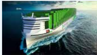
▲HD한국조선해양이 공개한 1만 5000TEU급 원자력(SMR) 추진 컨테이너선 설계모델./HD한국조선해양 제공
